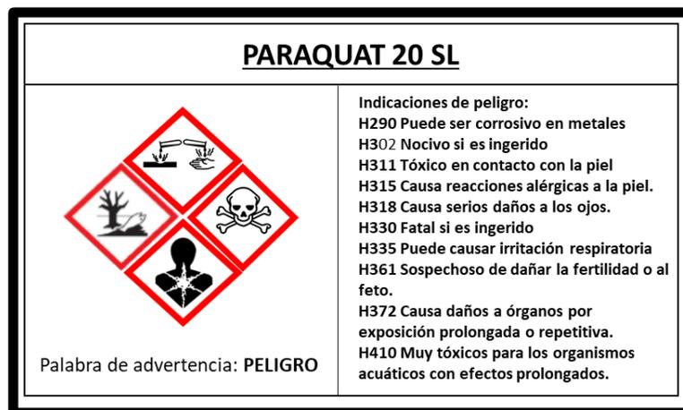
**Figura 37:** Etiqueta de identificación de peligros según SGA.
