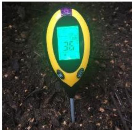
La medición de este parámetro se determinó por medio de un termómetro digital, este factor se controló durante 14 semanas, de lo cual se obtuvo un promedio semanal de 20,53°, con un mínimo de 8,7°C y un máximo de 32,4°C de temperatura. A continuación, se presenta gráficamente la recopilación de la información sobre el control de temperatura obtenida durante la aplicación del método de compostaje Takakura:
