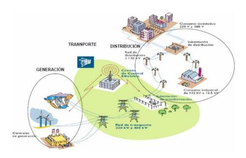
Figura 1 Sistema eléctrico básico. Fuente Red Eléctrica de España.
