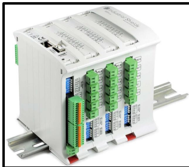
Figura 4. PLC, M-DUINO PLC Arduino Ethernet 50RRA.
