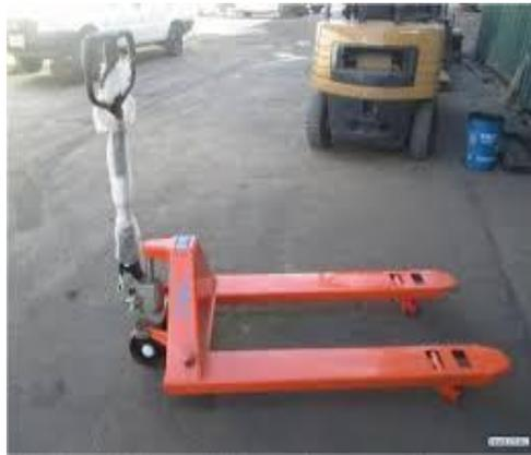
**Figura 18. Carretilla hidráulica**
