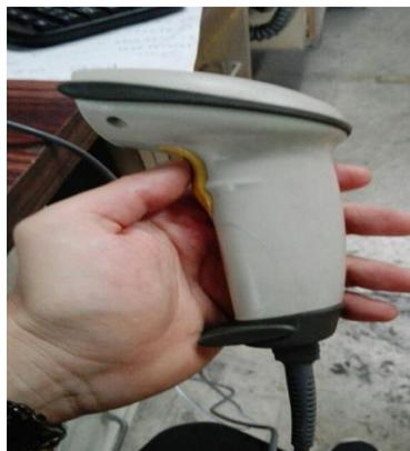
Hay dos tipos de rastreadores, de contacto y laser, los de contacto manual hacen contacto conforme recorren el material impreso que se debe leer. Los rastreadores con base en la tecnología láser son más versátiles y pueden leer datos que se pasan cerca del área de rastreo. Los rastreadores de las dos tecnologías pueden reconocer características impresos y varios tipos de códigos. (Long, 1995, p.142).
