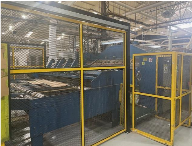
Figura 8 - Resguardo móvil del Stacker y banda de desecho de la impresora Hycorr
