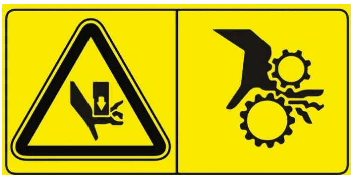
Figura 1 – Riesgo de atrapamiento
