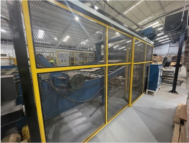
Figura 7 - Resguardo móvil del Stacker de la Impresora Hycorr
