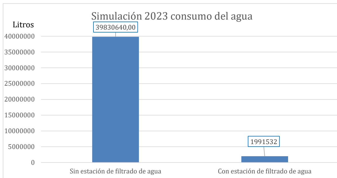
Figura 17 Ejemplo de ahorro de agua potable para las llenadoras
