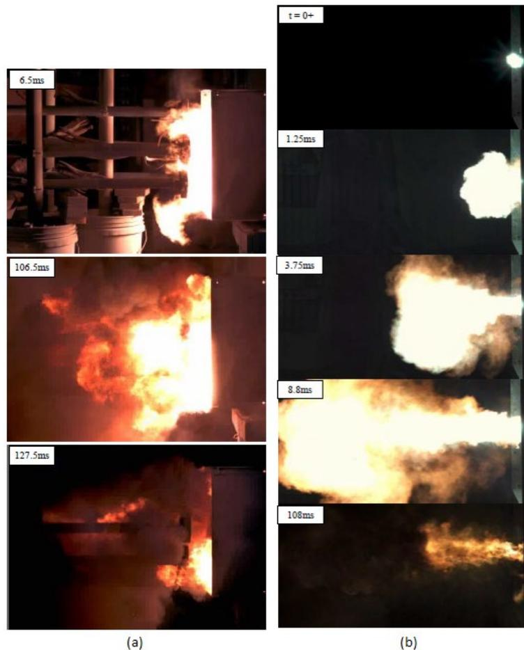
Fig. 63. a) Arco con electrodos verticales detrás de la caja, b) Arco con electrodos de descarga horizontal
