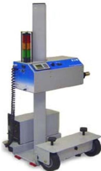
Fig. 64. Unidad de ajuste de potencia remota
