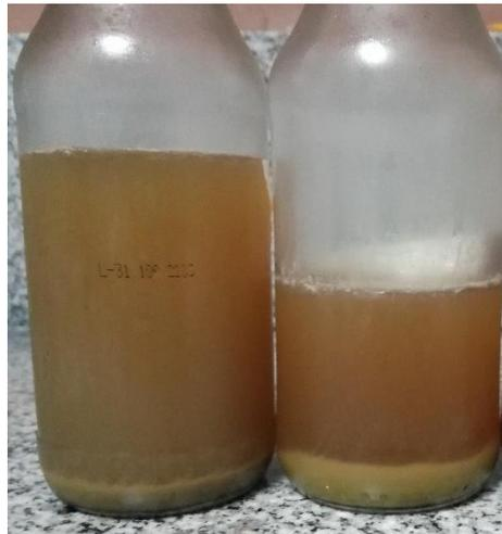
Para las siguientes pruebas realizadas solamente se utilizó pasteurización rápida, la variación es esta prueba fue el uso del sanitizante clorado, para analizar su influencia de igual forma en la vida útil del jugo de caña. La imagen representa el jugo almacenado a temperatura de refrigeración por los 15 días de vida útil. Como se observa es notorio el sedimento que se forma con el paso del tiempo. Se envían al laboratorio Lambda para ser analizadas.
