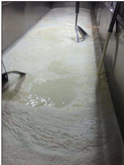
**Figura 3. Desuerado a nivel de cuajada y formación manual de los bloques de queso**
