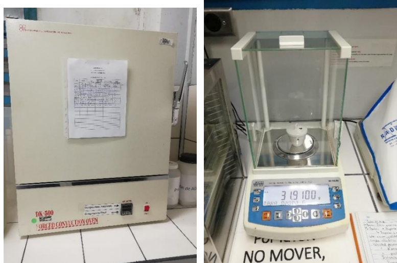
Figura 14. Horno de convección forzada modelo DK-500 y la balanza analítica modelo AS220.R2.
