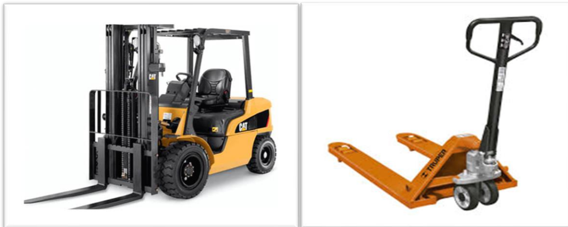
Figura 14. Montacarga y perra de carga
