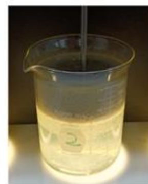
Mejor muestra 2ml coagulante 1.5ml floculante
