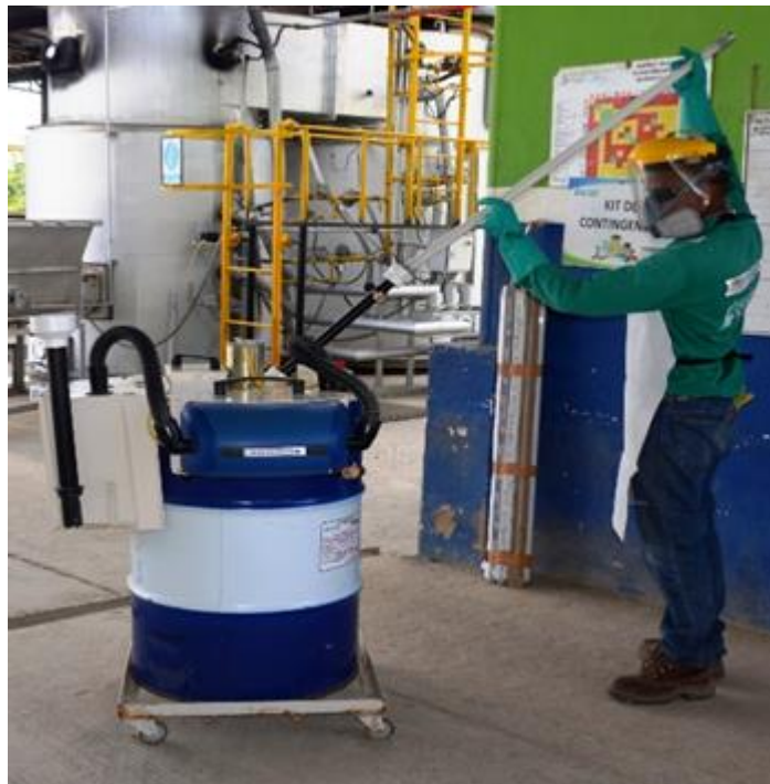
Ilustración 53. Proceso Tratamiento de Tóner
