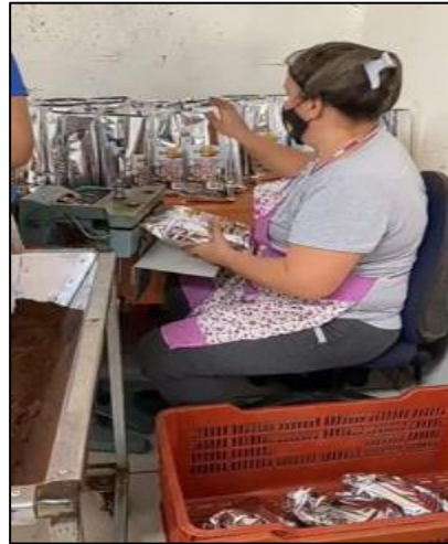
Figura 36 Análisis de la postura con método REBA en la toma de bolsa para sellar
