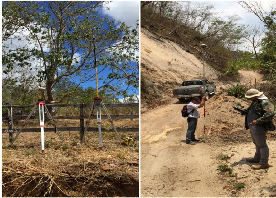
Figura 9. Levantamiento topográfico con estación total GPS
