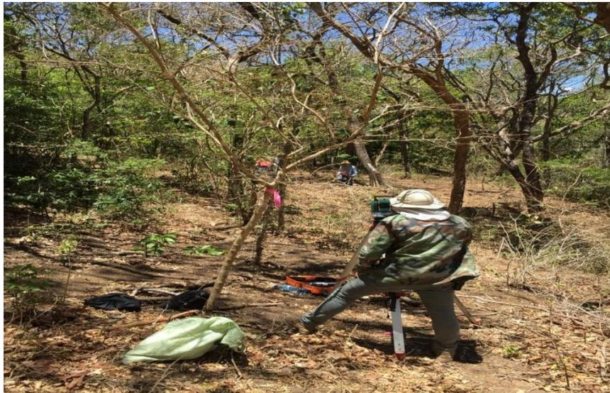
Figura 8. Levantamiento topográfico con estación total en la zona montañosa del Río Negro.
