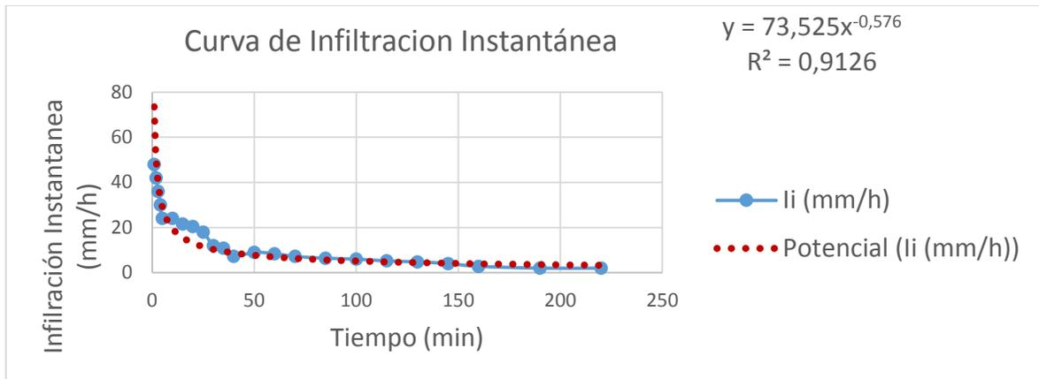
Figura 19. Curva de infiltración instantánea contra el tiempo en la parte baja del área de estudio
