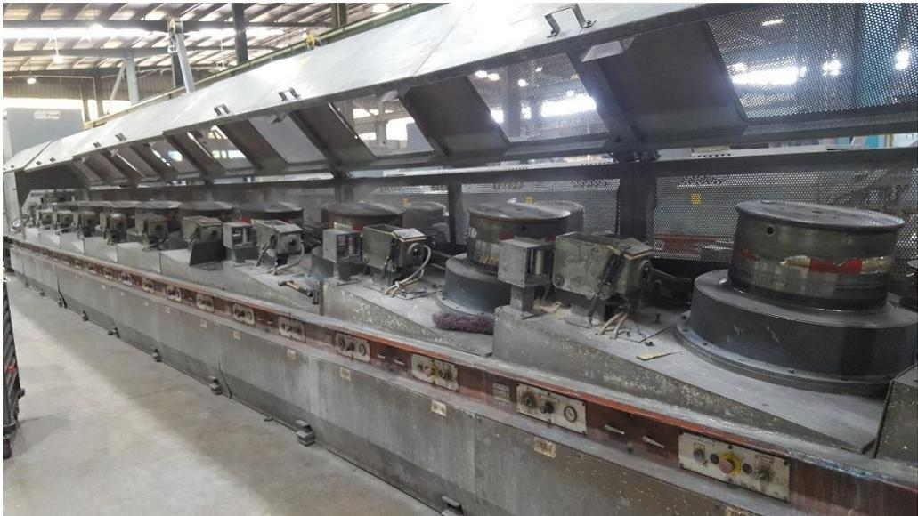
**Figura 12.** Interior de la máquina, acomodo de hileras
