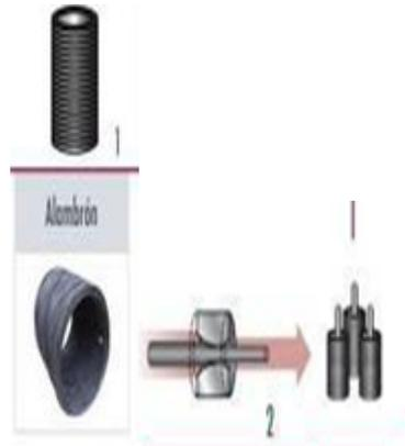
**Figura 13.** Representación del proceso de trefilado
