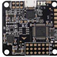
*Ilustración 5. Placa controladora de vuelo.*
