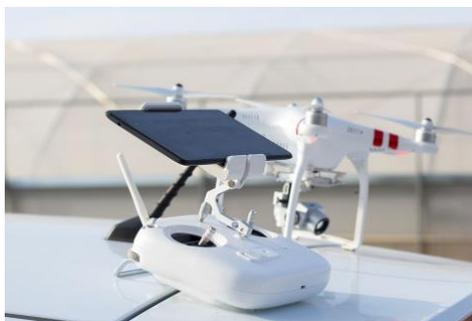
*Ilustración 9. Estación de control del VANT.*
