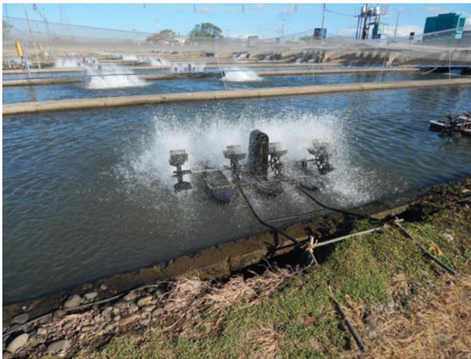
FIGURA 5. Aireación de estanques de tilapia de flujo intensivo operados por ACI.
