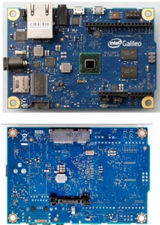
Figura 11. Placa de desarrollo Galileo de Intel
