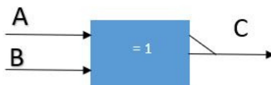
Figura 2.20. Símbolo electrónico en Norma IEC para la compuerta XNOR. Fuente: Elaboración Propia.
