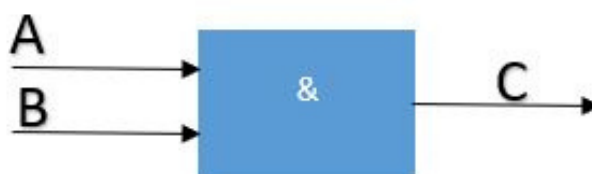
Figura 2.2. Símbolo electrónico en Norma IEC para la compuerta AND. Fuente: Elaboración Propia.
