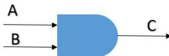
Figura 2.1. Símbolo electrónico en Norma ANSI para la compuerta AND. Fuente: Elaboración Propia.
